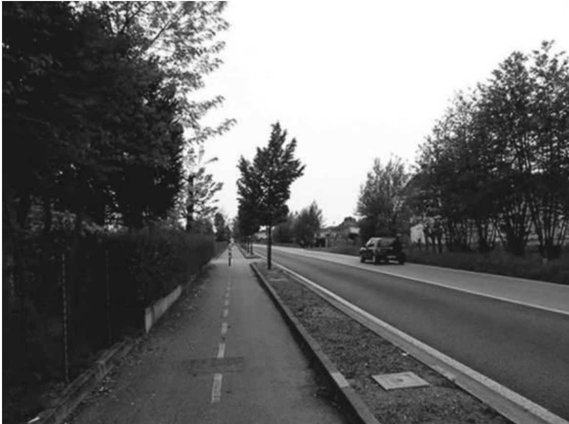
Εικόνα 3.1: Ποδηλατόδρομος διπλής κατεύθυνσης στο επίπεδο του οδοστρώματος, διαχωρισμένος με νησίδα
